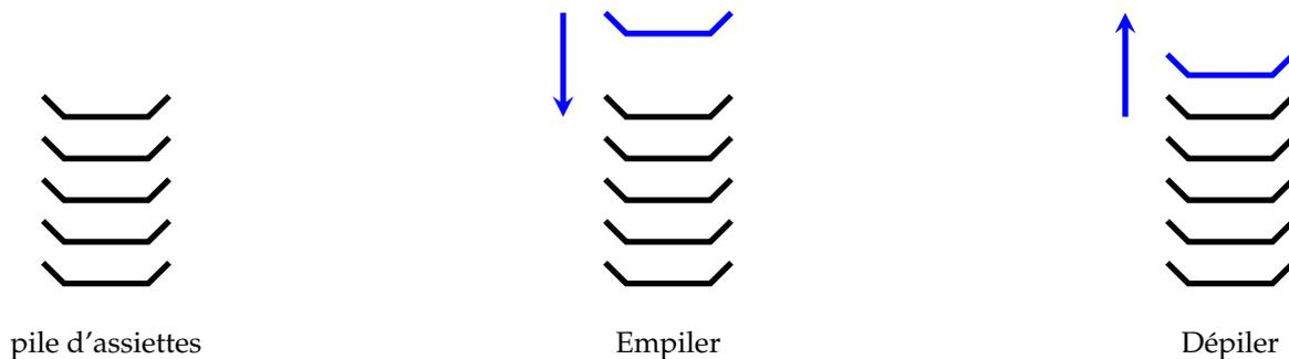
**LIFO** : La dernière assiette posée sur la pile sera la première que l'on va nettoyer. Ce principe est à la base d'une pile : « dernier arrivé, premier sorti » (LIFO en anglais pour *last in, first out*)
