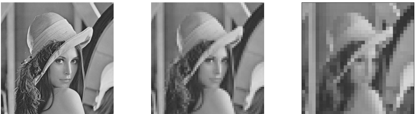
FIGURE 9 – Diminution de la résolution. L'image de départ est en 512 \times 512 . On a diminué la résolution d'un facteur 8 pour obtenir l'image du centre (de taille 64 \times 64 ) et d'un facteur 16 pour l'image de droite (de taille 32 \times 32 ).
