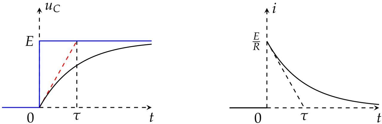
FIGURE 8 – Régime de charge pour le circuit  $(R,C)$
