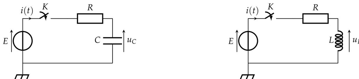
FIGURE 6 – À gauche, circuit  $(R, C)$  soumis à un échelon de tension (interrupteur fermé à l'instant  $t = 0$ ). À droite, circuit  $(R, L)$  soumis à un échelon de tension.
