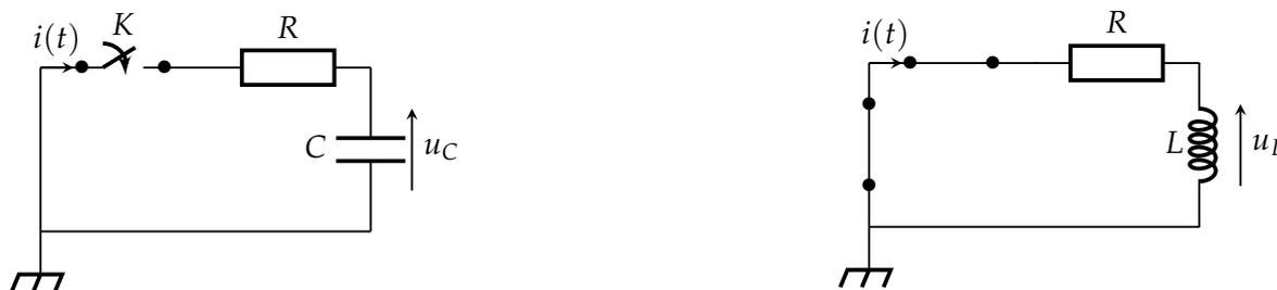
FIGURE 7 – À gauche, circuit  $(R, C)$  en régime libre. À droite, circuit  $(R, L)$  en régime libre.
