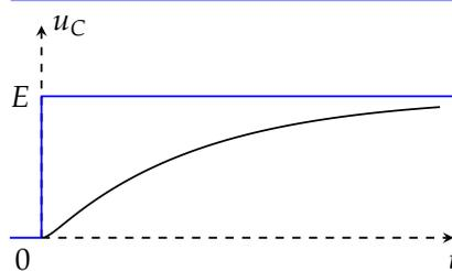
FIGURE 3 – Régime apériodique d'une charge de condensateur.
