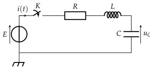
FIGURE 1 – Circuit  $(R,L,C)$  pour la charge du condensateur.
